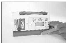
**Nota:** El soporte para trípode de 5/8-11 se alinea con la parte nivelada de la fotocélula y se utiliza para colocar el receptor en un trípode o placa para taludes.
