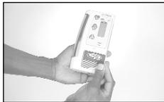
2. Deslice la ranura del receptor en la lengüeta de la abrazadera hasta que llegue hasta el tope.
