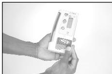
2. Deslice la ranura del receptor en la lengüeta del soporte hasta que llegue hasta el tope.
