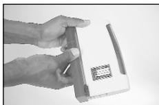
**Nota:** Las muescas para marcar a ambos lados del receptor/soporte magnético se alinean con la parte nivelada de la fotocélula y se utilizan para marcar lecturas de la posición vertical. Dichas muescas están a 50 mm (2 pulg.) de la parte superior del receptor/soporte magnético.
