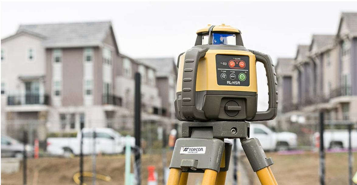
El RL-H5 de Topcon , es un laser rotatorio autonivelante, multi-usos, ideal para excavaciones, desplantes de plataformas con pendiente, preparación de terracerías, obras de concreto y otros proyectos de construcción general. Con su receptor láser, ofrece un rango largo que cubre hasta los 800mts de diámetro. Este nivel láser también ofrece una precisión de hasta  $\pm 1/16"$  o  $1/8"$  a 100 pies y se auto-nivela dentro de  $\pm 5$  grados.
